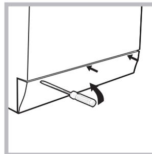
3. снимите переднюю панель стиральной машины при помощи отвертки (см. схему).
